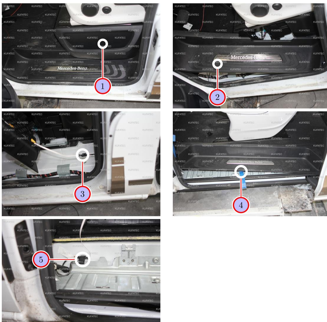
Abbildung 10: Demontage Einstiegsleisten vorne/hinten
