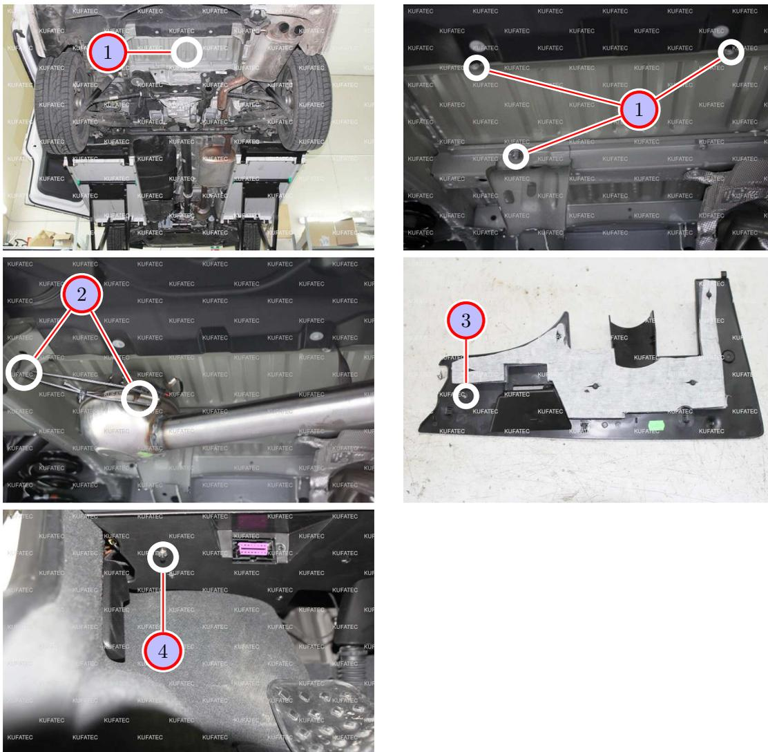
Abbildung 11: Montage Geräuscherzeuger / Taster
