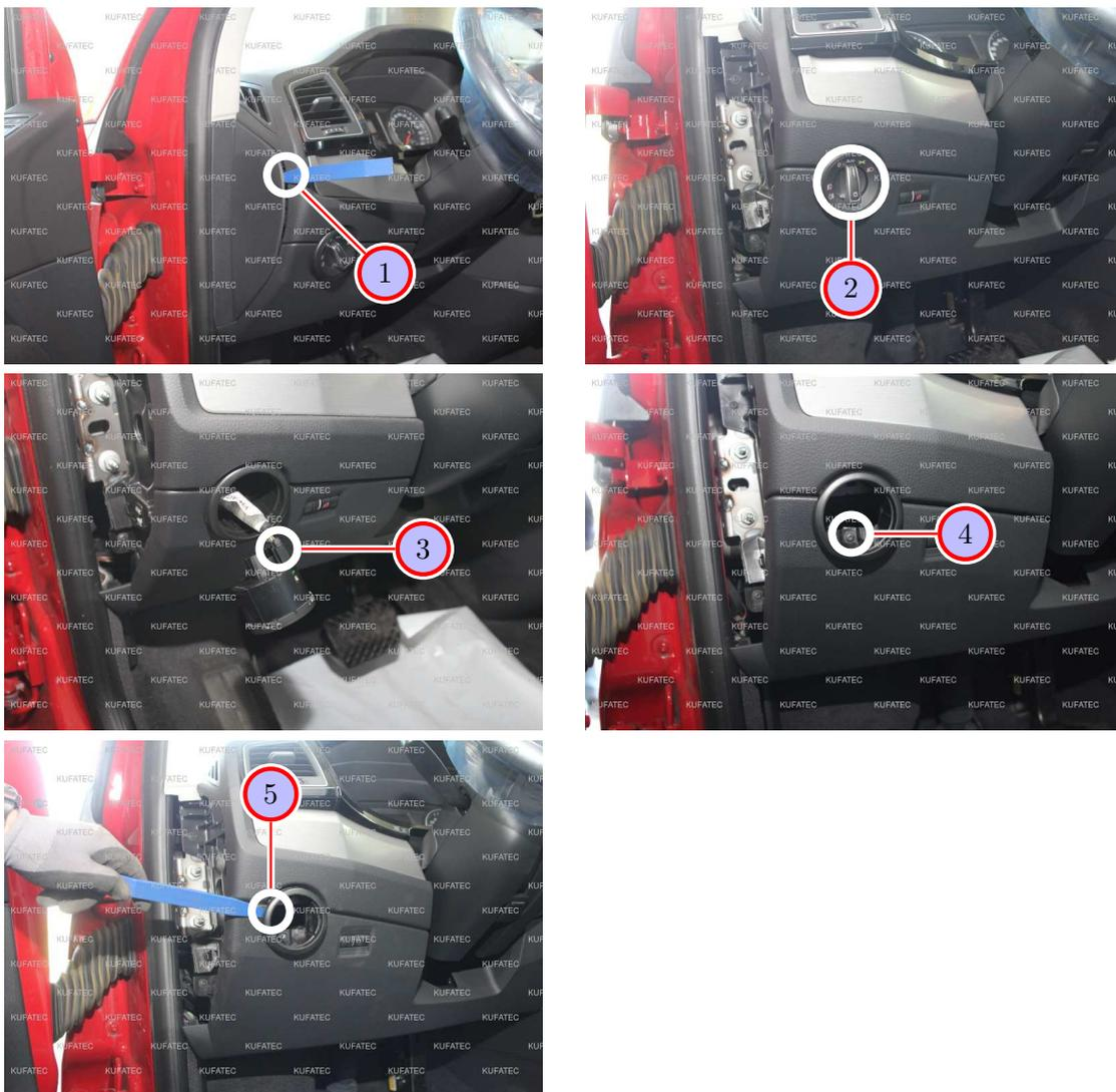
Abbildung 4: Demontage Verkleidung Fahrerseite
