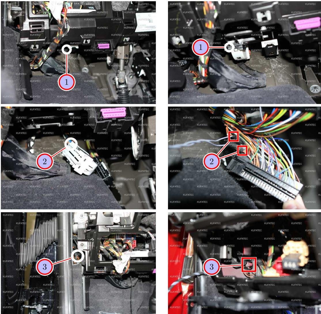
Abbildung 8: Anschluss Leitungssatz
