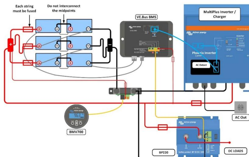
Le nostre batterie LFP sono dotate di bilanciamento e monitoraggio delle celle integrati. I cavi di bilanciamento/monitoraggio delle celle possono essere collegati in cascata e devono essere collegati a un Sistema di Gestione della Batteria (BMS).
