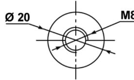
Anschluss: M8 Schraube oder M8 Poladapter
